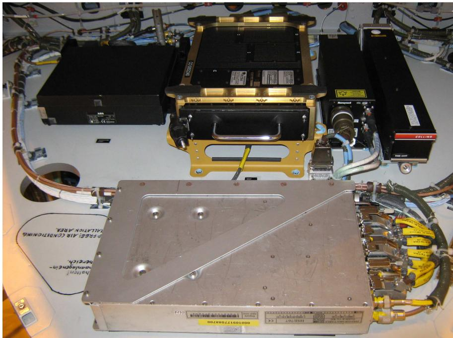
Verschiedenste taktische Ausrüstung [z.B. ein digitales Funkgerät für Behördenfunk (TETRA) und das Navigationssystem EuroNav 7] werden integriert.
