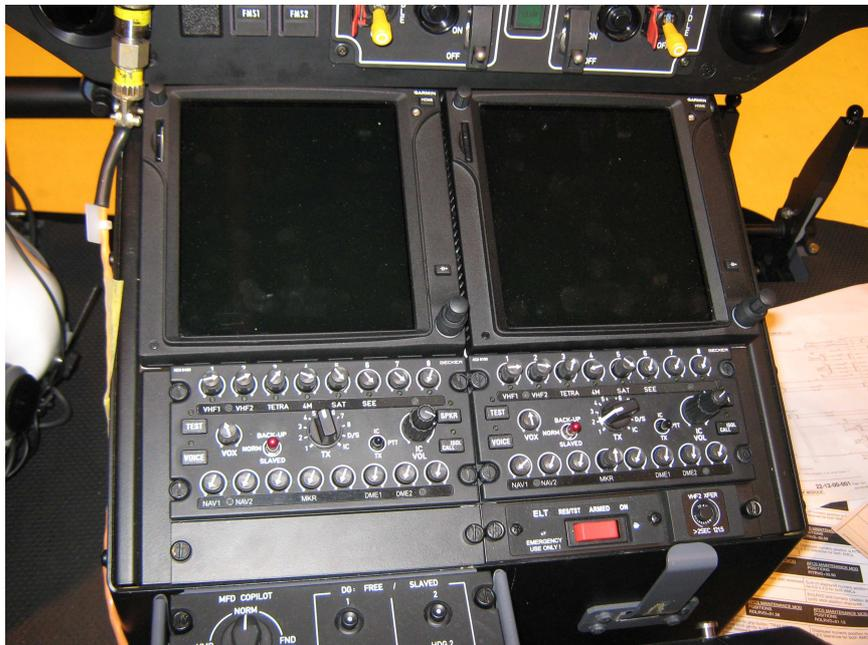
Hier die multifunktionalen Bildschirme der neuen "Helionix Avionic Suite" sowie zwei Garmin GTN750, letztere für kombinierte Com/Nav/GPS Funktionen.
